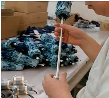
10. 手元の取付 Install handle
